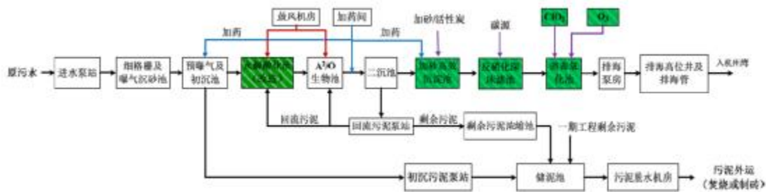
图 2-2 污水处理厂二期工程工艺流程图
